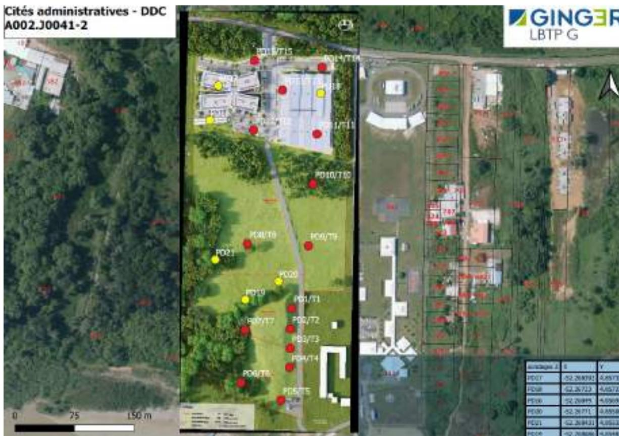
Figure 18 : Plan d'implantation des sondages géotechniques, mission G2
