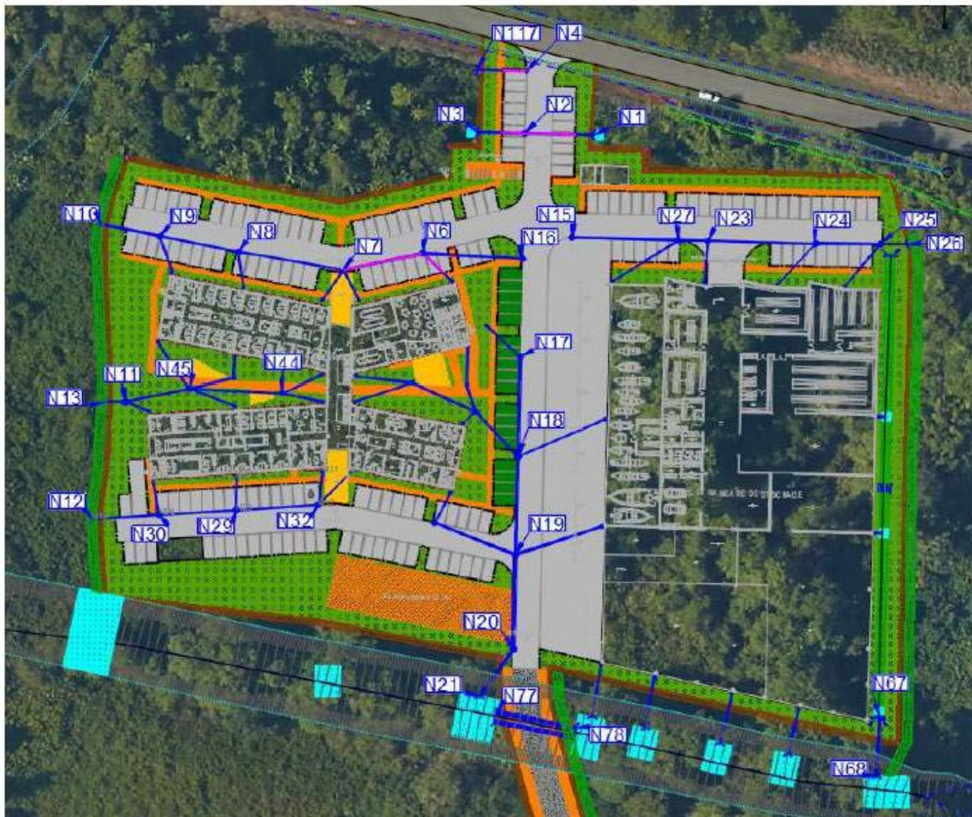
Figure 11 : Localisation des sections hydrauliques pour le réseau EP
