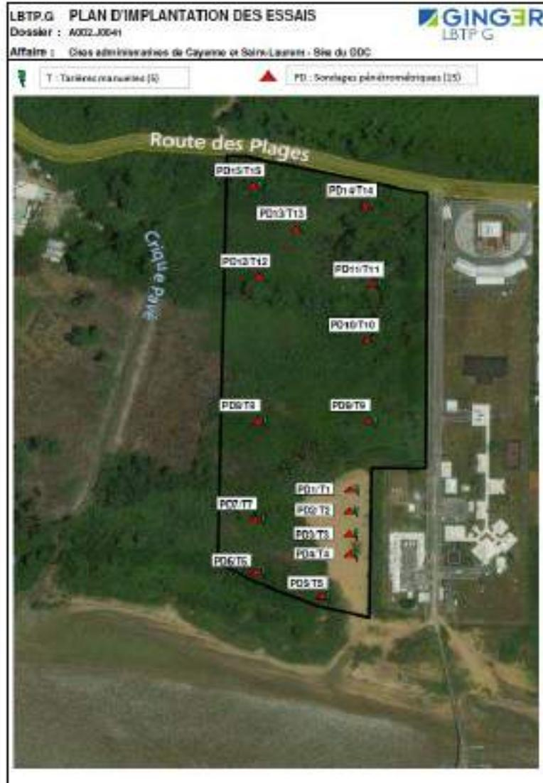
Figure 17 : Plan d'implantation des sondages géotechniques, mission G1
