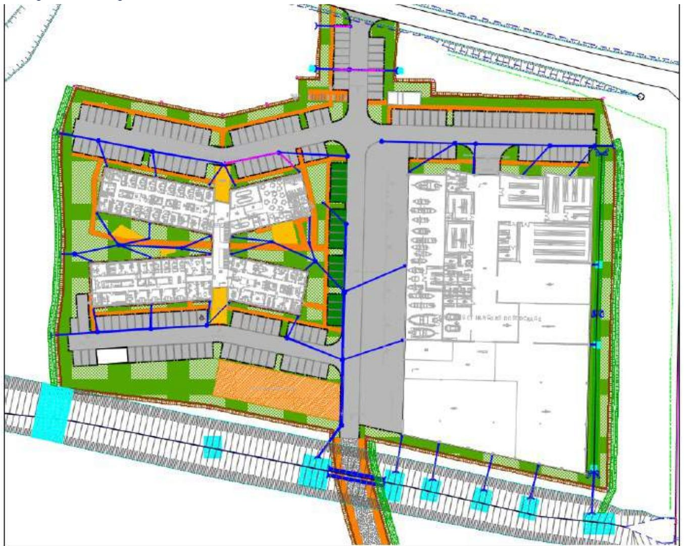
Figure 8 : Réseaux EP du projet (Source : Note hydraulique eaux pluviales, GTI septembre 2022)
